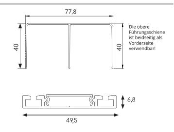
9 Legen Sie die Bodenschiene auf (Bitte noch nicht befestigen). Setzen Sie die Tür in die Decken- und Bodenschiene ein. Jetzt kann ausgelotet und an entsprechender Stelle markiert werden. Anschließend muss die Tür wieder ausgehängt werden.
