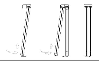
**11** Die mitgelieferten Anschlagbürsten werden einfach in das Griffprofil eingeschoben. Sie dienen einem gedämpften Wandanschlag.
