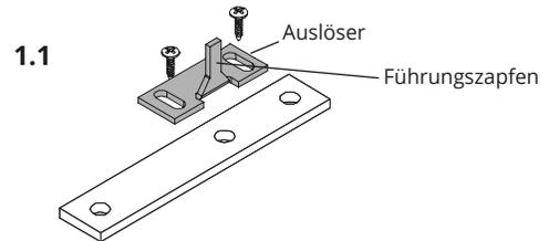
1.2 Führen Sie das Plättchen in das obere Querprofil ein. Beachten Sie einen Abstand von 30 cm, gemessen von der Außenkante Griffprofil bis zum Auslöseranfang. Schrauben Sie nun den Beschlag fest.
