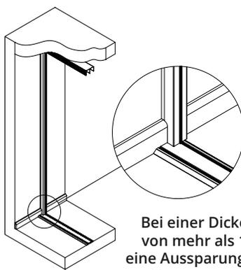
Bei einer Dicke des Sockels von mehr als 10 mm, muss eine Aussparung am Abdeckprofil vorgenommen werden.
