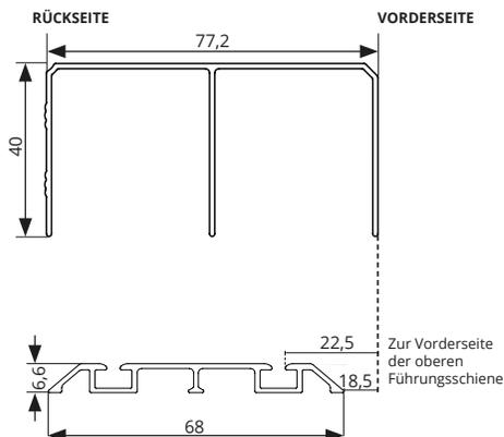
Sofern Sie die Bodenschiene **vor** Fertigstellung der Türflügel montieren wollen, können Sie sich an diesem Maß orientieren. **Wir empfehlen aber, die Schiene auszuloten wie in Schritt 2 beschrieben.**
