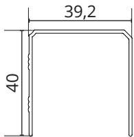
Die obere Führungsschiene ist beidseitig als Vorderseite verwendbar!
