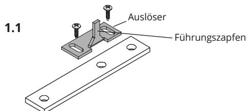
1.2 Führen Sie das Plättchen in das obere Querprofil ein. Beachten Sie einen Abstand von 14,5 cm, gemessen von der Außenkante Griffprofil bis zu der ersten Öffnung des Auslösers. Schrauben Sie nun den Beschlag fest.
