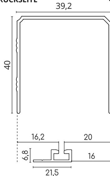
Die obere Führungsschiene ist beidseitig als Vorderseite verwendbar!
