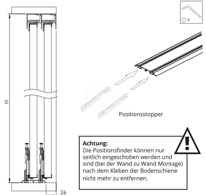
**Achtung:** Die Positionsfinder können nur seitlich eingeschoben werden und sind (bei der Wand zu Wand Montage) nach dem Kleben der Bodenschiene nicht mehr zu entfernen.
