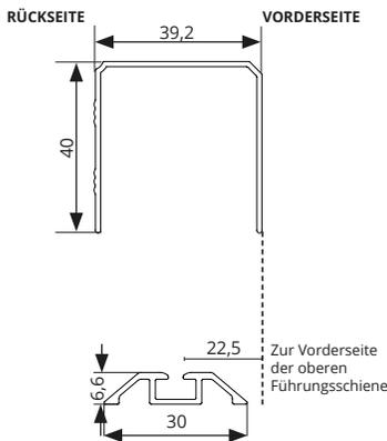
Sofern Sie die Bodenschiene vor Fertigstellung der Türflügel montieren wollen, können Sie sich an diesem Maß orientieren. **Wir empfehlen aber, die Schiene auszuloten wie in Schritt 2 beschrieben.**
