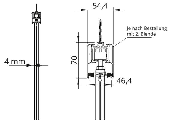
2 Jetzt können die oberen Rollen und die Positionsstopper in die obere Laufschiene geschoben werden.
