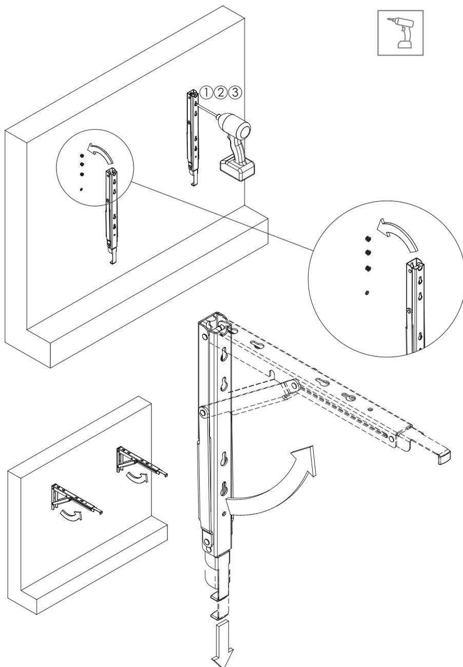
Klappen Sie im nächsten Schritt die beiden Beschläge auf.
