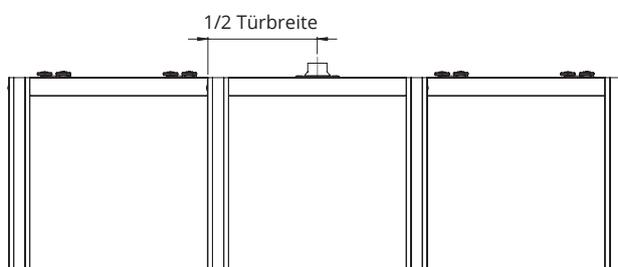
2.4 Der Führungszapfen muss nach vorne gerichtet sein. Die Platte muss, je nach Rahmenprofil, einige mm zur Vorderseite des Querprofils überstehen (siehe Abbildungen). Schrauben Sie nun den Beschlag fest.
