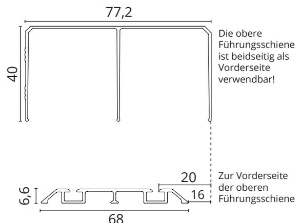
Die obere Führungsschiene ist beidseitig als Vorderseite verwendbar!
