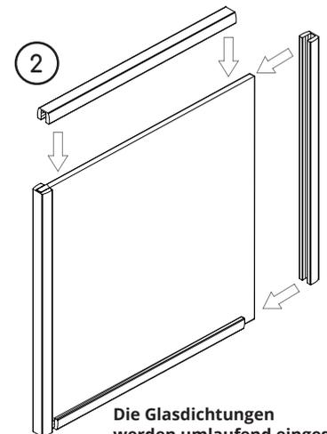
Die Glasdichtungen werden umlaufend eingesetzt.
