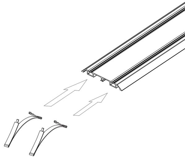
Schieben Sie die Positionsfinder an die gewünschte Stelle der Bodenschiene (hiermit legen Sie die Parkposition der Tür fest). Nun kann die Bodenschiene an der zuvor markierten Stelle geklebt werden (doppelseitiges Klebeband auf Bodenschiene vorhanden).
