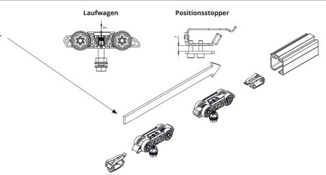
**5** Befestigen Sie nun die vormontierte Laufschiene durch einclipsen in das Wanddistanzprofil.
