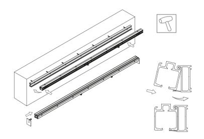
6 Montieren Sie jetzt die Aufnahmebeschläge. Wir empfehlen einen Abstand von 40 mm.
