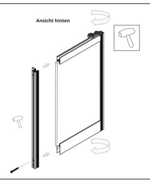
7 Clipsen Sie die zweite, obere Führungsrolle am Ende des oberen Querprofils ein und verschrauben sie das Griffprofil mit dem oberen und unteren Querprofil.
