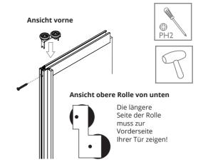
**6** Befestigen Sie nun das zweite seitliche Griffprofil mit dem Gummihammer.
