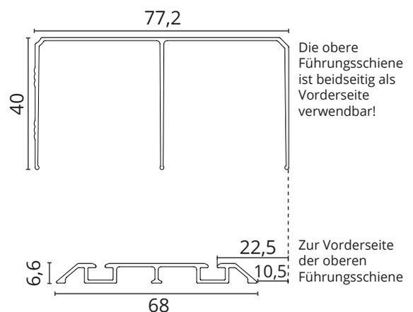
Sofern Sie die Bodenschiene **vor** Fertigstellung der Türflügel montieren wollen, können Sie sich an diesem Maß orientieren. **Wir empfehlen aber, die Schiene auszuloten, wie in Schritt 9 beschrieben.**
