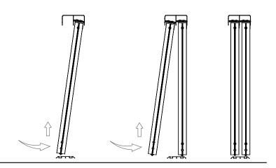
**11** Die mitgelieferten Anschlagbürsten werden einfach in das Griffprofil eingeschoben. Sie dienen einem gedämpften Wandanschlag.
