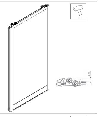
7 Verschrauben Sie das Griffprofil mit dem oberen und unteren Querprofil.
