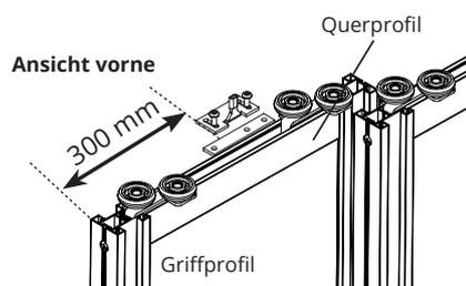
2.4 Der Führungszapfen muss nach vorne gerichtet sein. Die Platte muss, je nach Rahmenprofil, einige mm zur Vorderseite des Querprofils überstehen (siehe Abbildungen). Schrauben Sie nun den Beschlag fest.
