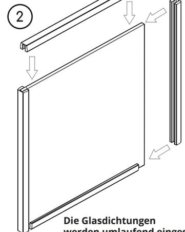
Die Glasdichtungen werden umlaufend eingesetzt.
