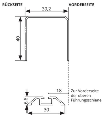
Sofern Sie die Bodenschiene vor Fertigstellung der Türflügel montieren wollen, können Sie sich an diesem Maß orientieren. **Wir empfehlen aber, die Schiene auszuloten wie in Schritt 2 beschrieben.**
