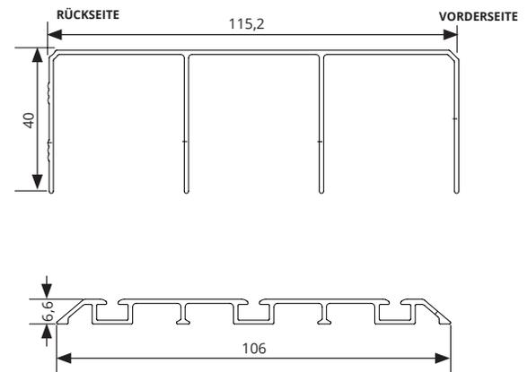
Sofern Sie die Bodenschiene vor Fertigstellung der Türflügel montieren wollen, können Sie sich an diesem Maß orientieren. **Wir empfehlen aber, die Schiene auszuloten wie in Schritt 2 beschrieben.**
